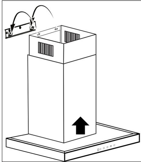
**NOTA:** As duas aberturas de ventilação estão posicionadas no duto/corpo na parte superior, com um diâmetro de 6mm. Deite o tubo de exaustão para a saída da parede. Fixe o tubo de exaustão com a braçadeira na saída da parede.
