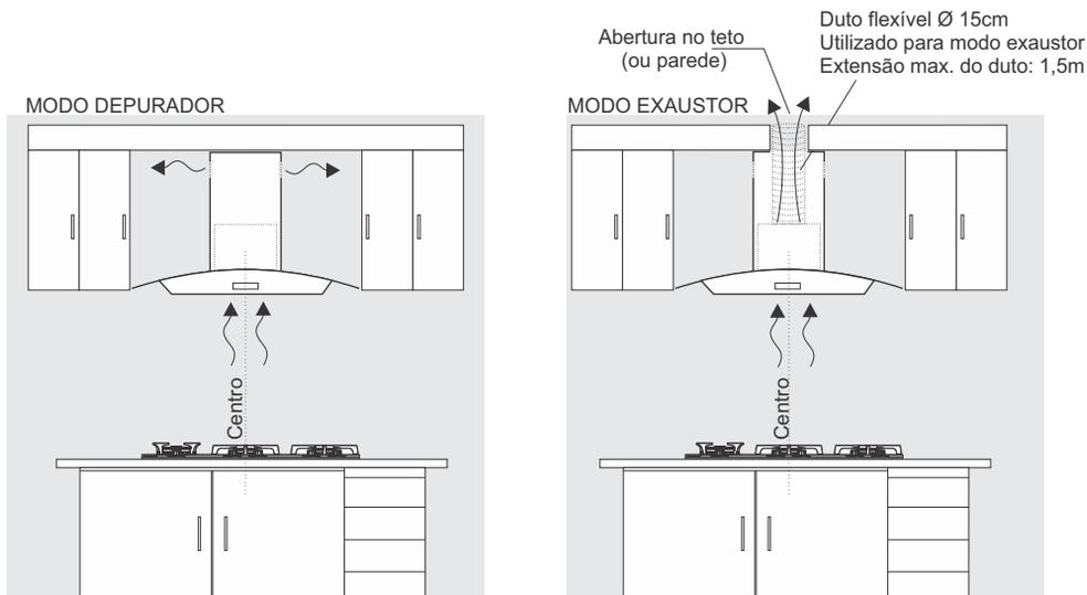
Para fixação, centralizar a linha de centro da coifa com o centro do fogão/cooktop. Com uma trena, achar a altura entre o fogão e a base da coifa, conforme indicado neste manual (65 a 80 cm). Utilizar o gabarito de fixação e marcar a posição dos furos para fixação da coifa. Verificar se a altura da coifa até o teto não é superior a a altura máxima do duto de inox (vide desenho acima).
