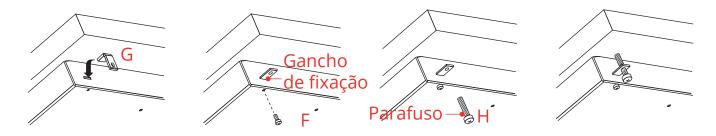
Encaixe o cooktop na abertura feita no móvel e fixe-o com os parafusos correspondentes dos ganchos de fixação.
