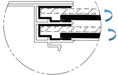
Ao encaixar o vidro no perfil superior (conforme imagem acima), o mesmo sairá do perfil inferior (conforme imagem a seguir) para remoção total.
