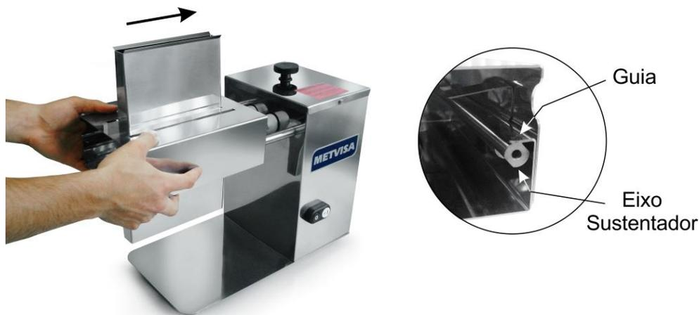
Ao remontar os rolos na gaveta, posicione a fenda dos rolos para o lado de dentro da gaveta. Note que no rolo 01 existe um disco e o mesmo deverá ser montado encostado com a chapa da gaveta. Outra atenção que deverá ter, é referente a primeira lâmina do rolo 02. A lâmina terá que ficar por trás do disco do rolo 01, conforme imagem abaixo.
