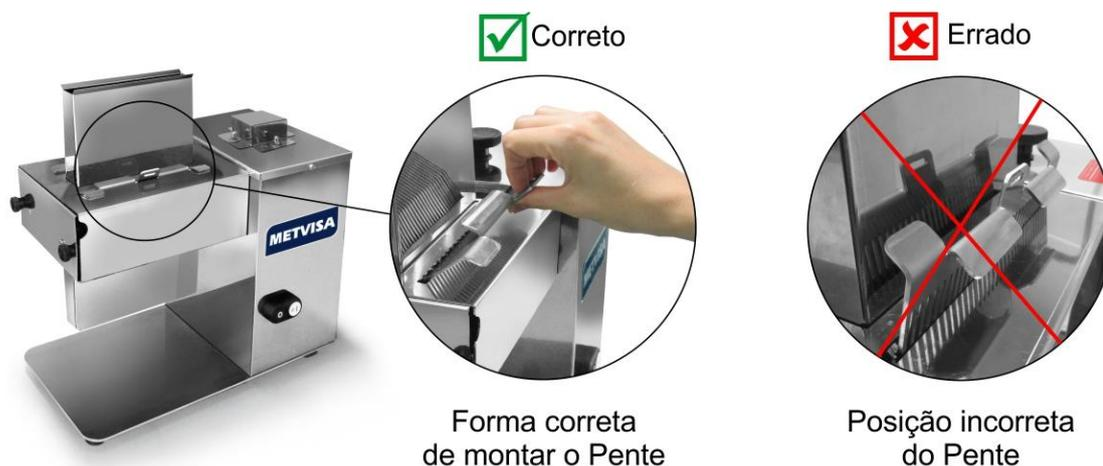
Monte todas as peças perfeitamente para que seja garantida a segurança do operador e o correto funcionamento do aparelho. Se alguma peça não estiver firme, pode não ter sido encaixada corretamente. Neste caso, repita a operação e não obtendo êxito, contate a assistência técnica.
