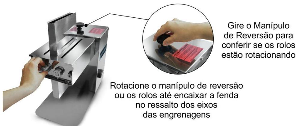
Com os rolos encaixados, monte a tampa frontal fixando-a com os dois manípulos, e a proteção do manípulo de reversão com as porcas. Por último coloque o pente com o pegador virado para fora.
