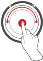
Ao invés de Gestos [► 18], é possível alterar as configurações girando a roda de ajuste central. Confirme as ações pressionando a roda de ajuste central.
