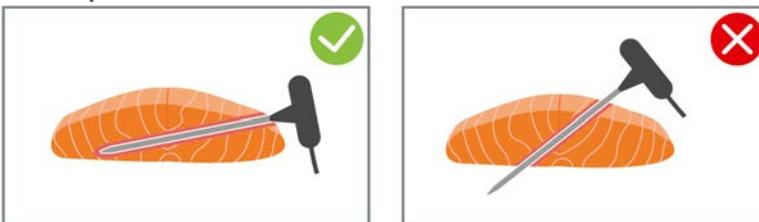
1. Coloque o sensor de temperatura de núcleo inteiro na diagonal de forma que ele entre o máximo possível no alimento.
