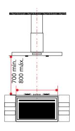
A coifa deve ser instalada numa parede plana e vertical. Verifique se a parede de instalação é resistente para suportar o peso da coifa. Paredes laterais ou armários devem estar a uma distância minima de 60 mm da coifa; Marque o centro do cooktop, fogão ou rangetop e faça uma linha vertical até o teto, para a fixação e alinhamento do suporte;
