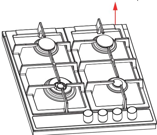
O ponto de conexão do botijão de gás ou do gás canalizado devem estar localizado no máximo a 1 m do centro do cooktop, em local de fácil acesso para permitir a conexão e inspeção.
