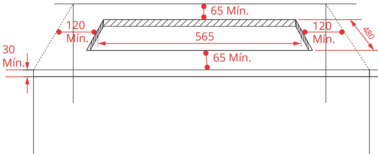
Recomendamos a instalação apoiando na aba da parte metálica, pois oferece maior resistência.
