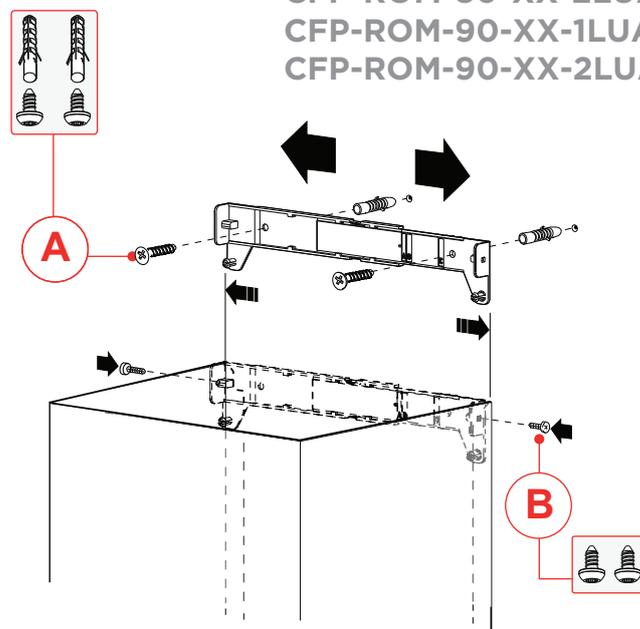
Faça 3 furos de Ø8 mm utilizando o suporte de fixação da coifa como guia e com a altura de instalação acertada, mantenha-o nivelado e insira as buchas nos furos.
