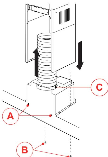
Instale o tubo de exaustão fixando-o na de saída de ar com a braçadeira plástica.
